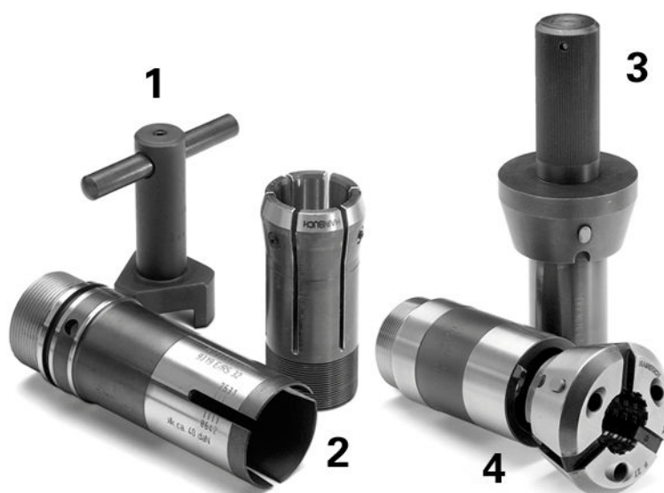
Exemple : Dispositif de montage des pinces d'avance et du système Spanntop (marque Hainbuch)
