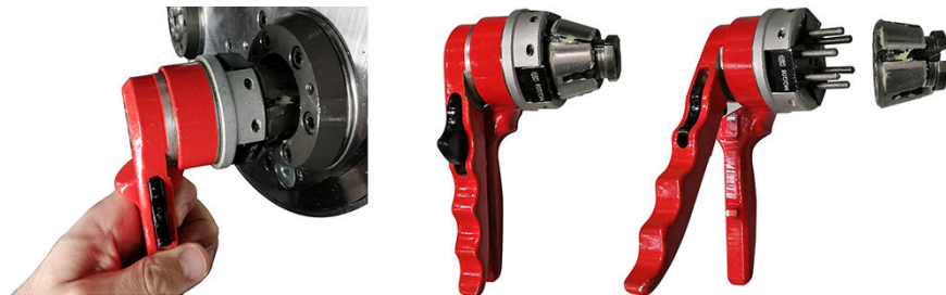
Exemple : Dispositif de changement manuel et hydraulique (marque Hainbuch)
