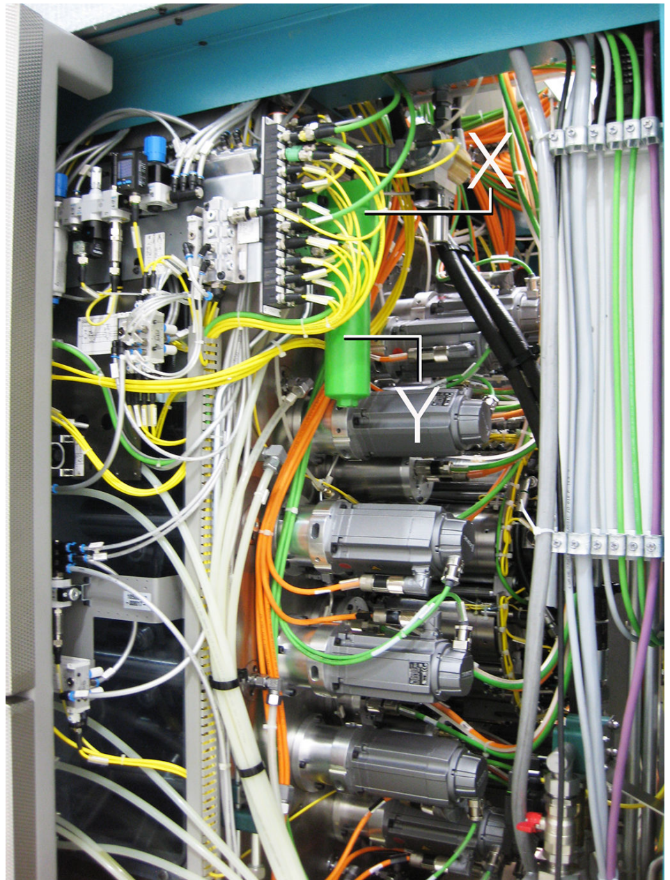
Exemple : Filtre hydrostatique
