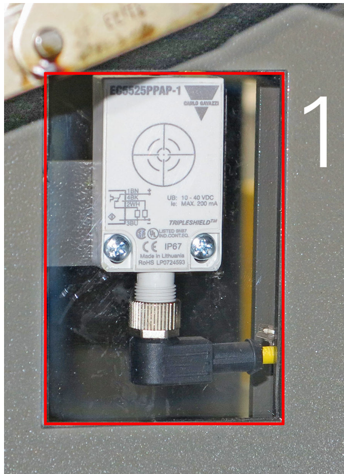
Abbildung 3: Sichtscheibe am Sensor (Ansicht von innen)
