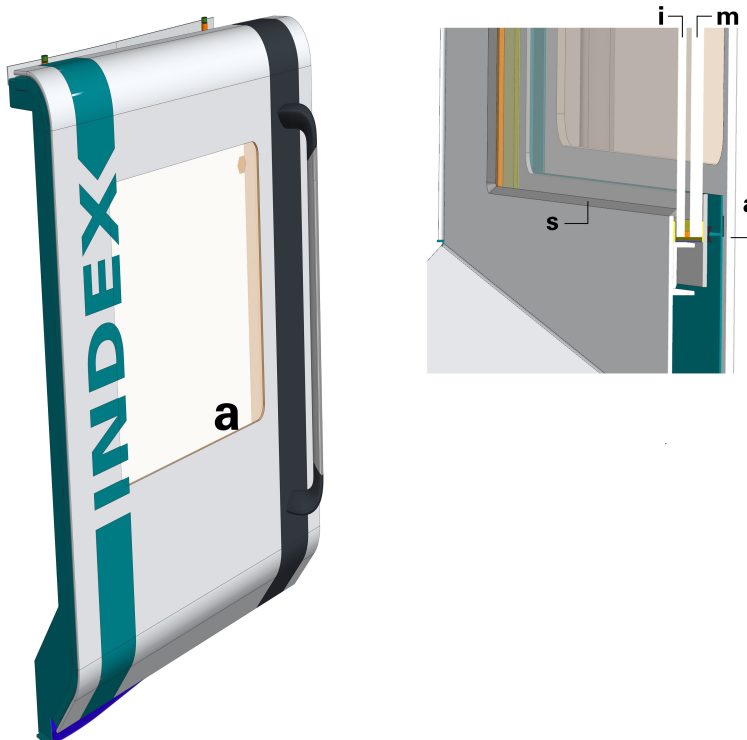
Exemple : MS32-6.3 Vitre d'observation de la porte de l'espace de travail 1 (Fig. 1)
