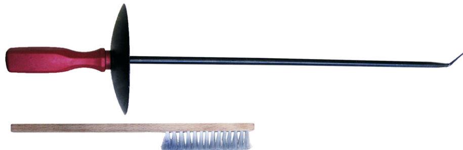
Exemple : Outils appropriés – crochet et brosse à copeaux
