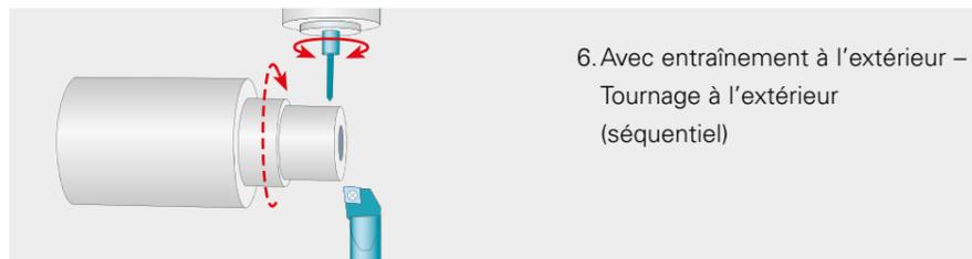
6. Avec entraînement à l'extérieur – Tournage à l'extérieur (séquentiel)
