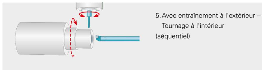
5. Avec entraînement à l'extérieur – Tournage à l'intérieur (séquentiel)
