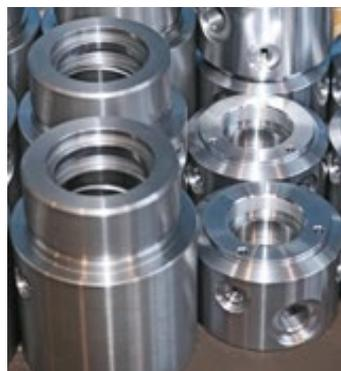
Führungen (Ø 110×120 mm) und Böden (Ø 75×50 mm) für Zylinder, die in der Dämpfertechnik eingesetzt werden.
