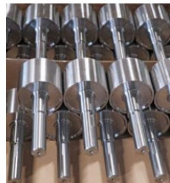
Lünetten-Arbeit aus dem Vollen: Die Teile mit 110 mm Durchmesser und 125/270 mm Länge waren vorher Schweißrohreile.
