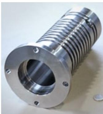
Dieses anspruchsvolle Bauteil (Ø 140×320 mm) fertigte Lieb aus dem Vollen. Es enthält viele Einstiche, ist komplett durchgebohrt und ausgedreht.
