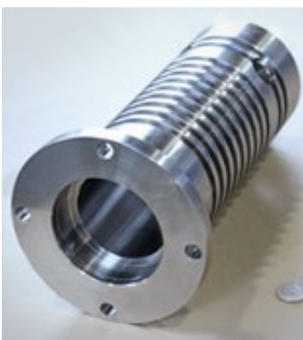
Lieb a fabriqué ce composant complexe (Ø 140x320 mm) dans le brut. Il comprend de nombreuses entailles, est complètement percé de part en part et tourné.
