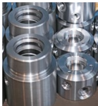
Dispositif de guidage (Ø 110x120 mm) et bâtis (Ø 75x50 mm) pour vérins utilisés dans la technique d'amortissement.
