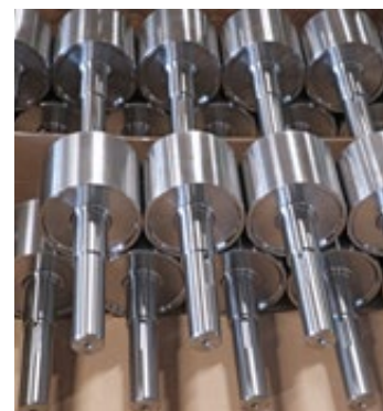
Travail à la lunette dans la masse : les pièces de 110 mm de diamètre et de 125/270 mm de long étaient auparavant des pièces brutes destinées au soudage.
